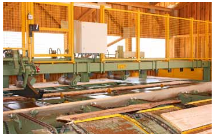
Combimes-Line bei Hupfloher: Zuführung, Vereinzlung, Ausschleusung, Kappung, Vermessung, Einzug
