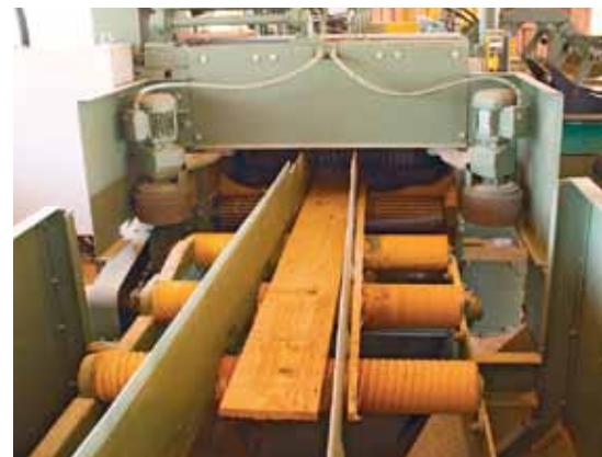
Hinter dem DK90-Besäumer separiert eine Abscheider die Spreißel automatisch
