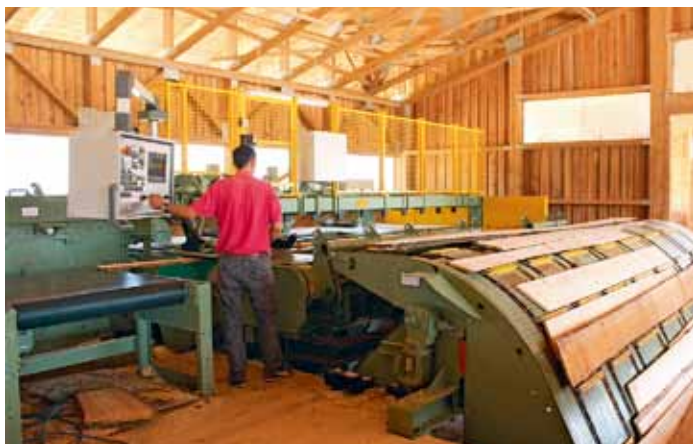
Erleichtert die Arbeit im Kleinstsägewerk: Combimes-Line mit DK90-Kreissäge von EWD als universelle Besäum- und Nachschnittkreissäge
